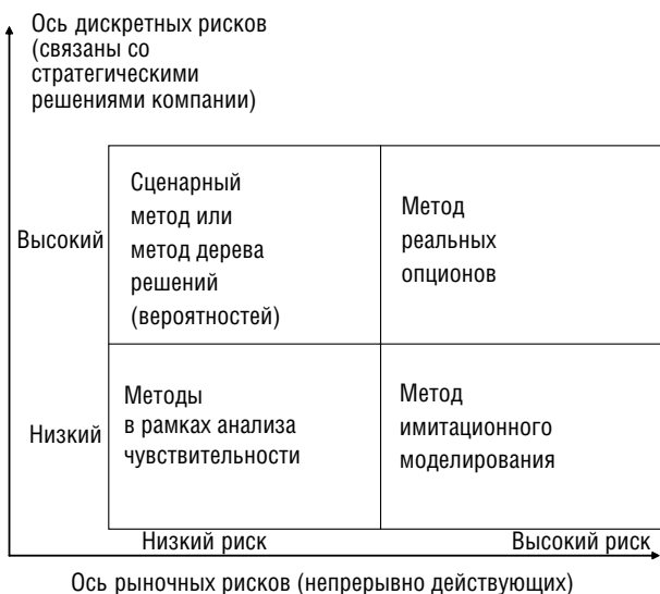
Рис. 13.10. Соотношение дискретных и рыночных рисков и выбор метода оценки риска в оценке эффективности проекта
